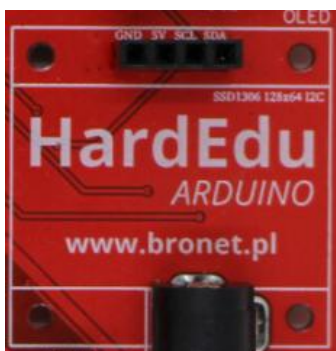
Rys. 2. Zdjęcie gniazda wyświetlacza OLED z opisem wyprowadzeń.
